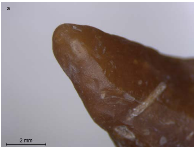
Afb. 7.6 Sterk afgeronde booruiteinden van boortjes V1249 (a) en V82 (b).
